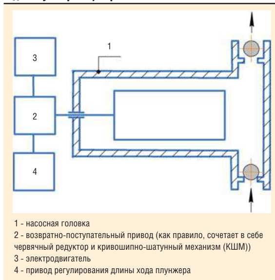
Рис. 1. Односторонний (одноголовочный, одноплунжерный) агрегат
