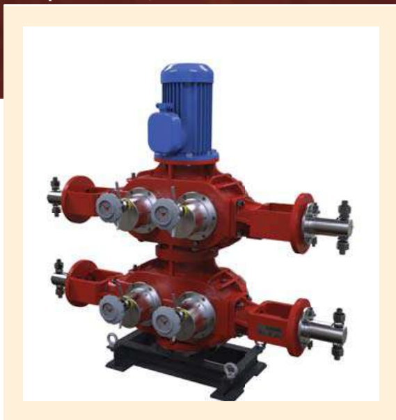
Рис. 5. Блочный агрегат с вертикальным расположением главного вала с двумя плунжерными оппозитными насосами и мощностью электродвигателя 7,5 кВт
