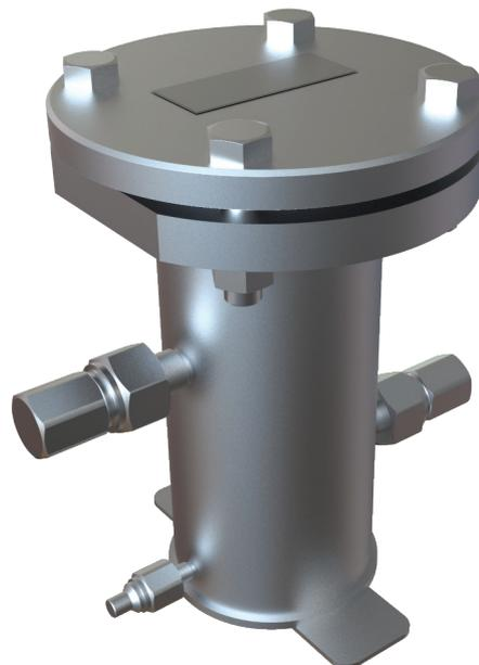
Фильтры сетчатые жидкостные типа ФС, ФСЖ предназначены для очистки от механических примесей агрессивных, токсичных и вредных жидкостей, эмульсий и суспензий. Фильтры устанавливаются на всасывающих линиях дозирующих насосных агрегатов и установок.
