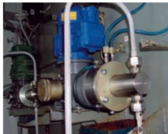
Рис. 2. Герметичный плунжерный дозировочный насос М8 производства ООО «Завод дозировочной техники «Ареопаг» в БРХ к.52 Мыхпайского месторождения ОАО «Самотлорнефтегаз»
